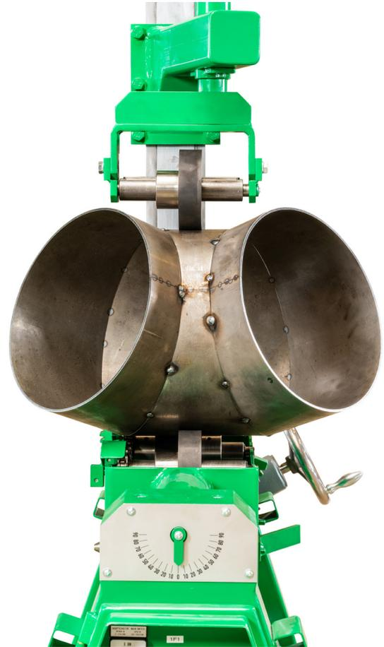
Spannen und Drehen eines weit gekrümmten Segmentkrümmers.
